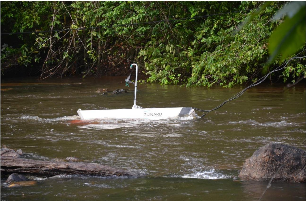
Figure 2 - Hydrolienne Poseide 66 sur le site du CNRS Nouragues - Guyane (source: Guinard Energies Nouvelles – groupe Acti)
