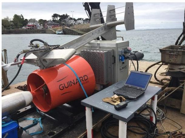
Figure 1 : Montage de l'hydrolienne sur la barge
